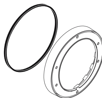
Rozeta przedłużająca 22mm (przy montażu w cienkich ścianach)
